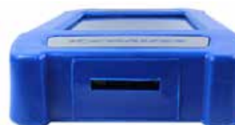
Fig. 3. Ranura para tarjeta MicroSD.
