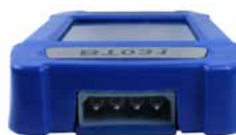
Fig. 2. Conector del cable de diagnóstico.
